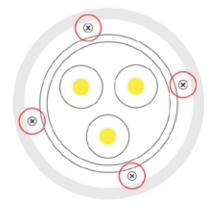
Montieren Sie den Reflektor an dem Lampenkörper mit den vier Schrauben
